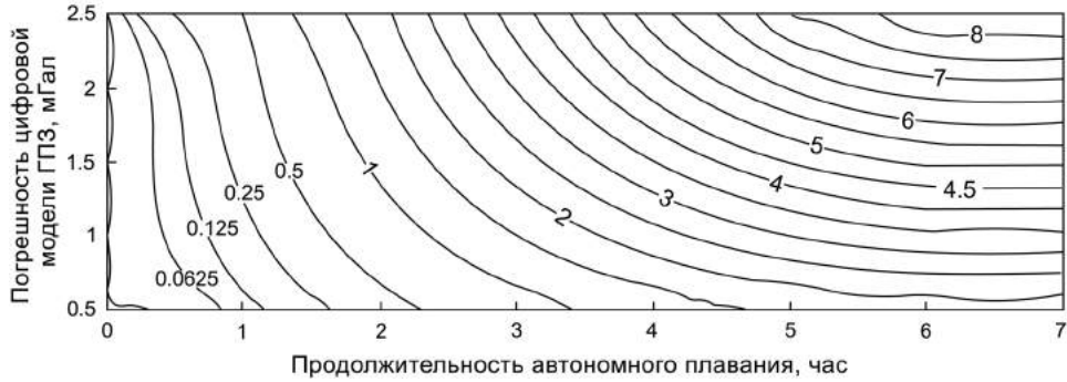
Рис. 1. Изменение СКП координат места объекта в километрах, вырабатываемого инерциальным НК с использованием модели ГПЗ различной точности
