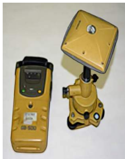
Рис. 10. Аппаратура позиционирования по CHC GPS «Topcon GB-500»
