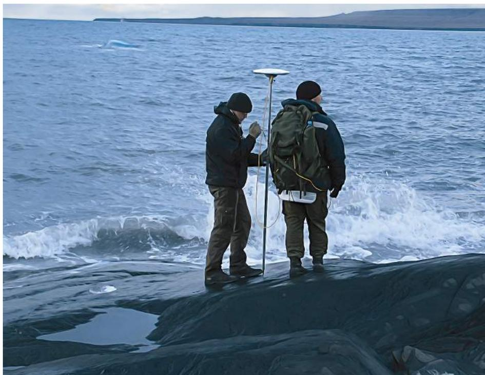
Рис. 4. Выполнение топосъемки береговой линии в заливе Серова с использованием приемника «Trimble R7»
