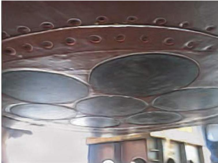
Рис. 3. Антенны донного профилографа
