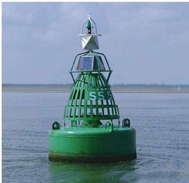
Рис. 7. Латеральный буй с решетчатой конструкцией
