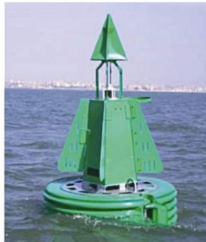
Рис. 14. Буи с крыльями, повторяющими силуэт топовой фигуры
