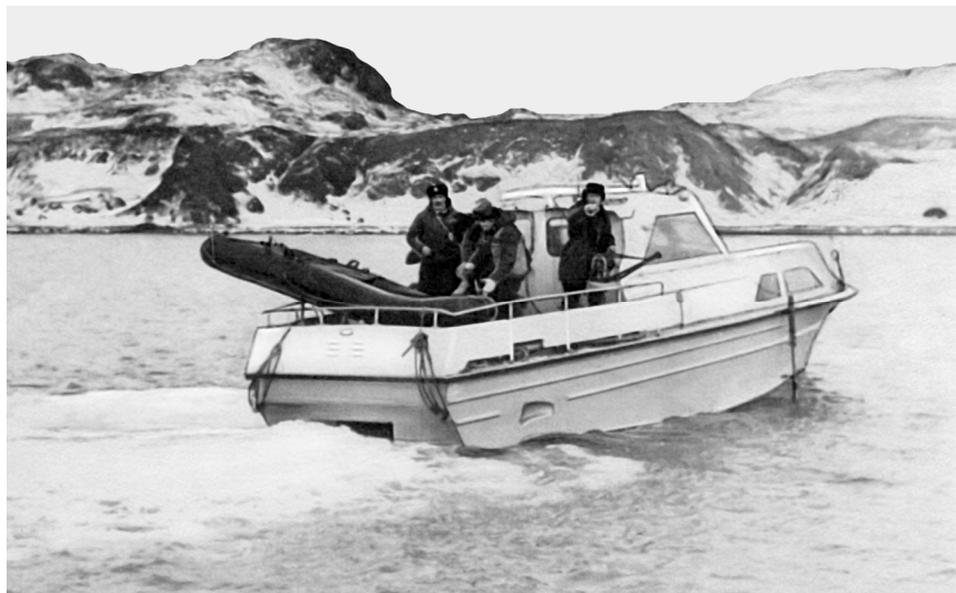
Рис. 1. Малый гидрографический катер на промере
