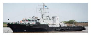
Водоизмещение (полное) - 320 т; длина - 36,4 м, ширина - 7,8 м, осадка - 2 м; скорость хода - 11,7 уз; дальность плавания - 1500 миль; автономность - 10 сут; экипаж - 11 чел.
